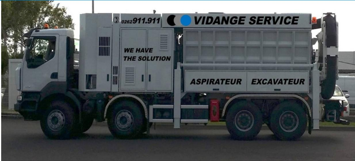
*Véhicule RSP type ESE 32 sur châssis 32 tonnes
